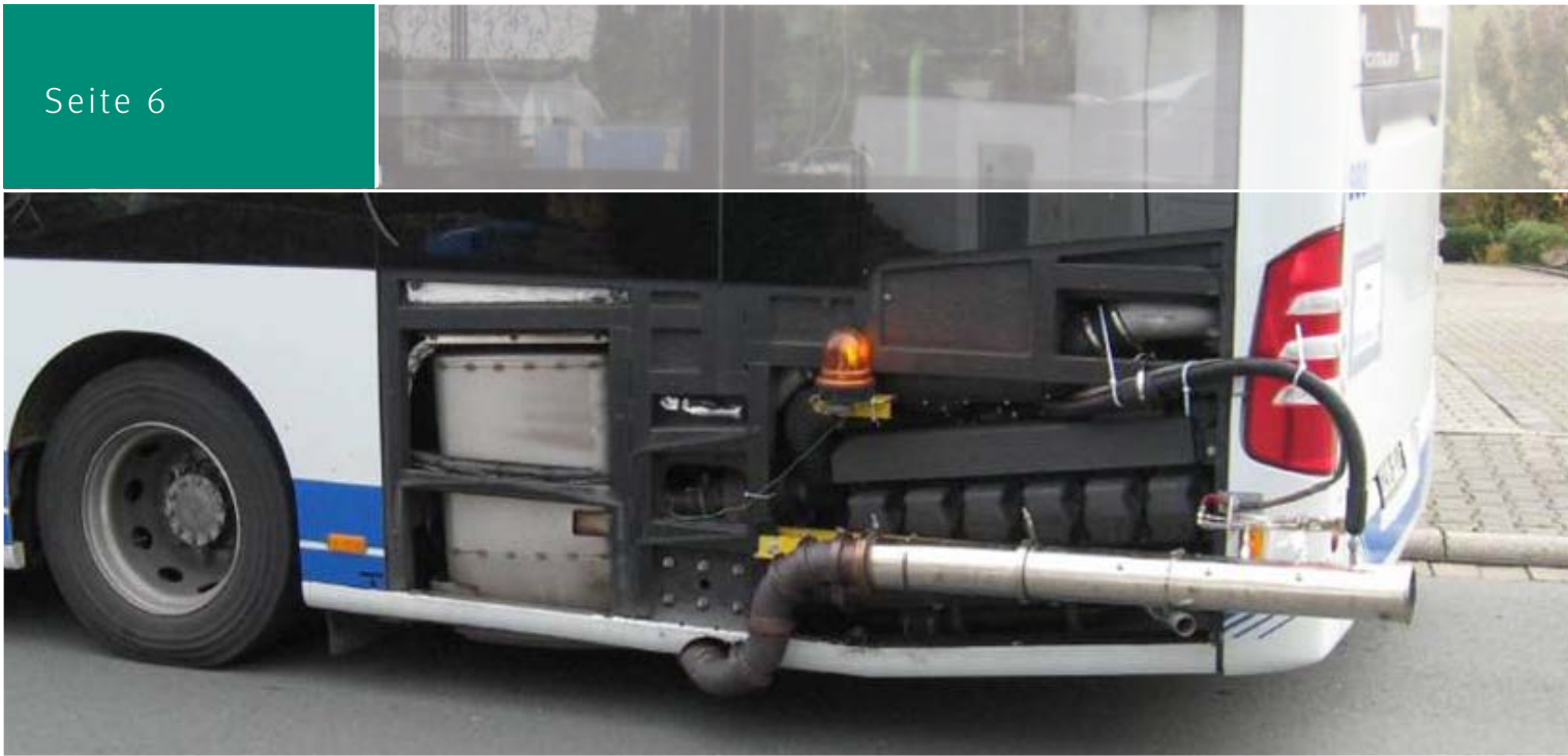
⤴ Emissionsmessung während einer Messfahrt
