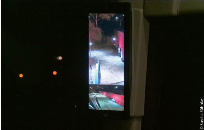
Ist Außenbeleuchtung vorhanden, liefern die Kameras ein ordentliches Bild
