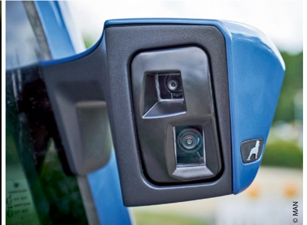
Je eine Kamera für das Normal- und das Weitwinkelbild sind verbaut
