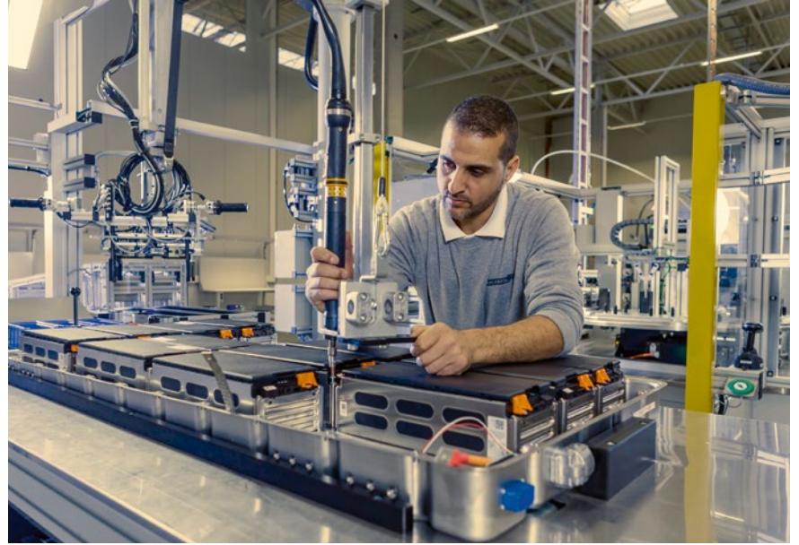
Das Bestücken des Systems erfolgt nach dem Auflegen des Batterie-Managementsystems halbautomatisch. Die Verschraubung wird für jede einzelne Schraube elektronisch dokumentiert
