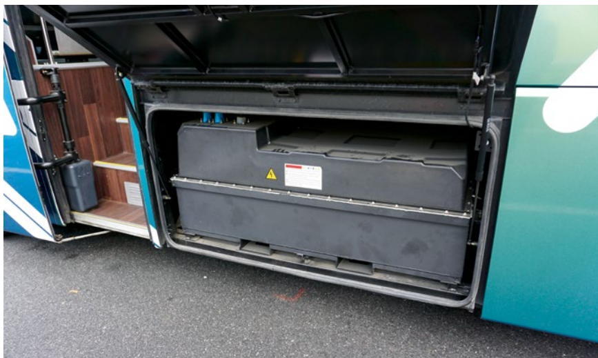
Die Batterie für den E-Flixbus von Hersteller BYD macht sich in einem kompletten Kofferraum breit
