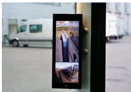
Kamerabasierte Systeme werden nach und nach konventionelle Spiegel ablösen
