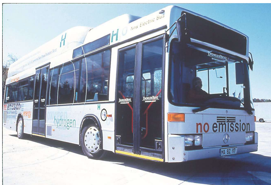
Der Mercedes-Benz Nebus war ein Wasserstoff-Brennstoffzellenbus von 1997
